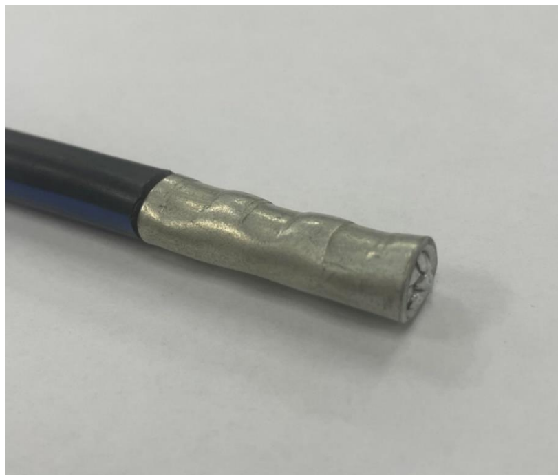
Рисунок 16 - Пример обжата многожильного провода
